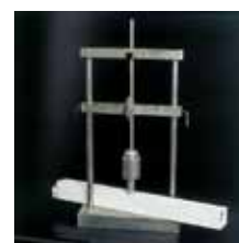
Attrezzatura per prova urti a bassa temperatura.
