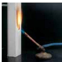
Attrezzatura per prova resistenza alla propagazione della fiamma.
