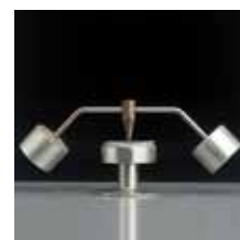
Attrezzatura per prova resistenza al calore.
