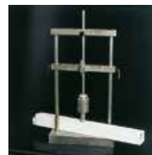
Attrezzatura per prova urti a bassa temperatura.
