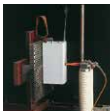
Attrezzatura per prova calore anormale (850°C) GWT.
