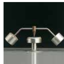
Attrezzatura per prova resistenza al calore.
